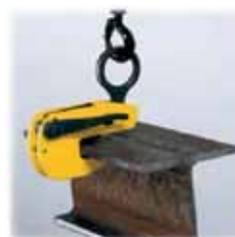
Levier de verrouillage (blocage de sécurité)
