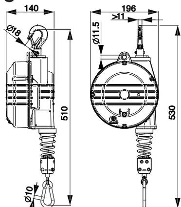
Suspension rotative par crochet de sécurité
