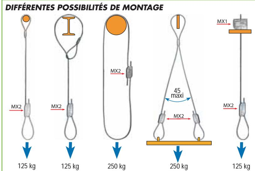
**ATTENTION :** charge utile statique en kg (coefficient de sécurité 5)
