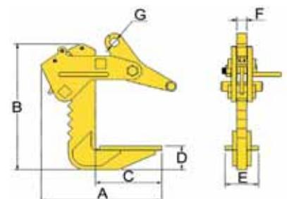
L'angle de tête d'élingage ne doit pas être supérieur à 90° ! Ne jamais lever plus d'une tôle ou d'un paquet de tôles cerclées à la fois !
