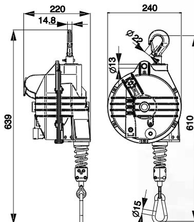
Suspension rotative par crochet de sécurité
