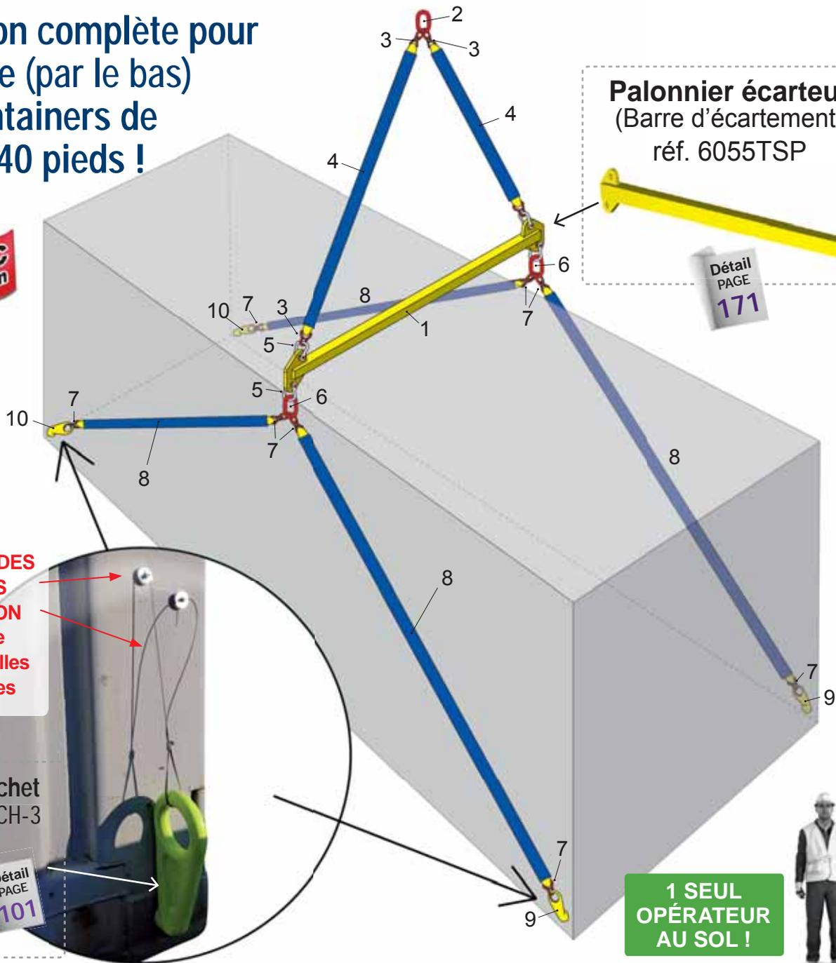
MAINTIEN DES CROCHETS EN POSITION par câblette avec rondelles magnétiques
