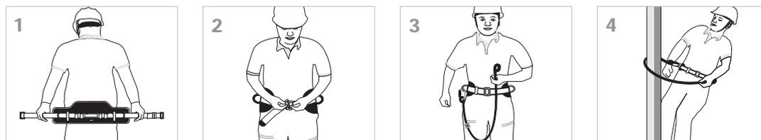
La longueur de la longe se règle en agissant sur l'ajusteur inclus de façon à travailler confortablement avec les 2 mains libres, le poids du corps est supporté par le dossier de la ceinture.
