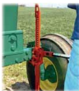
Levier à système d'engrenage à cliquet
