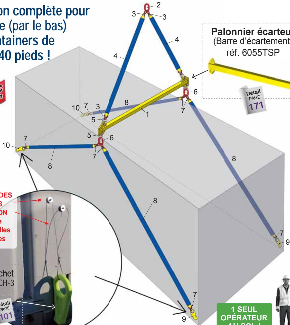
MAINTIEN DES CROCHETS EN POSITION par câblette avec rondelles magnétiques
