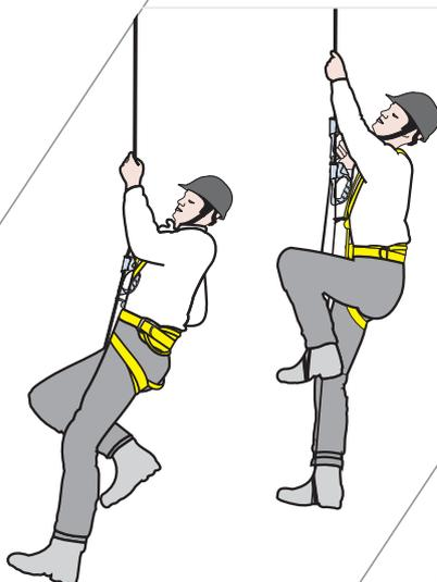
**ACCÈS SUR CORDE** : Cette technique de progression sur corde ne doit être utilisée que lorsque les méthodes d'accès traditionnelles ne peuvent pas être mises en place. L'équipement de base de l'accès sur corde devra être couplé avec un système antichute
