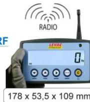
Afficheur LCD rétro-éclairé, 6 chiffres de 25mm, haut contraste, icônes des fonctions activées
