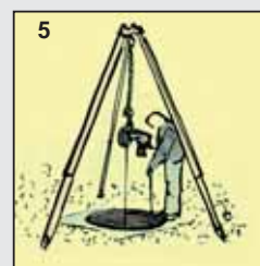
5 Levage de charge au-dessus d'un puits
