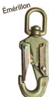
5266AZ060 acier galva ouverture 21 mm 180 x 58mm, 380 gr.
